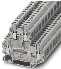
Bauelementreihenklemme, Der max. Strom wird durch die Diode bestimmt. Eingebaut: Diode 1N 4007, Sperrspannung: 1300 V, Dauergrenzstrom: 0,5 A., mit integrierter Diode, Nennstrom: 0,5 A, Anschlussart: Schraubanschluss, 1. und 2. Etage, Bemessungsquerschnitt: 2,5 mm<sup>2</sup>, Querschnitt: 0,14 mm<sup>2</sup> - 4 mm<sup>2</sup>, Montageart: NS 35/7,5, NS 35/15, Farbe: grau
