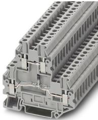
Bauelementreihenklemme, Der max. Strom wird durch die Diode bestimmt. Eingebaut: Diode 1N 4007, Sperrspannung: 1300 V, Dauergrenzstrom: 0,5 A., mit integrierter Diode, Nennstrom: 0,5 A, Anschlussart: Schraubanschluss, 1. und 2. Etage, Bemessungsquerschnitt: 2,5 mm<sup>2</sup>, Querschnitt: 0,14 mm<sup>2</sup> - 4 mm<sup>2</sup>, Montageart: NS 35/7,5, NS 35/15, Farbe: grau
