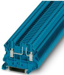
Trennklemme, Strom und Spannung werden durch den eingesetzten Stecker bestimmt., mit Prüfbuchschrauben zur Aufnahme von Prüfsteckern, Nennspannung: 400 V, Nennstrom: 20 A, Thermischer Dauerstrom  $I_{th}$ : 20 A, Anschlussart: Schraubanschluss, Bemessungsquerschnitt: 2,5 mm<sup>2</sup>, Querschnitt: 0,14 mm<sup>2</sup> - 4 mm<sup>2</sup>, Montage: NS 35/7,5, NS 35/15, Farbe: blau
