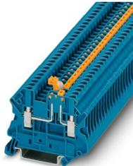
Messertrennklemme, Nennspannung: 400 V, Nennstrom: 20 A, Anschlussart: Schraubanschluss, Bemessungsquerschnitt: 2,5 mm<sup>2</sup>, Querschnitt: 0,14 mm<sup>2</sup> - 4 mm<sup>2</sup>, Montage: NS 35/7,5, NS 35/15, Farbe: blau
