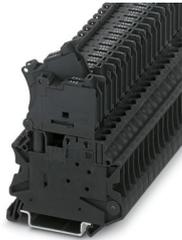
Sicherungsreihenklemme, mit Prüfbuchschrauben zur Aufnahme von Prüfsteckern, Art der Sicherung: Glas / Keramik / ..., Sicherungstyp: G / 5 x 20, Nennspannung: 24 V, Nennstrom: 6,3 A, Polzahl: 1, Anschlussart: Schraubanschluss, Bemessungsquerschnitt: 4 mm<sup>2</sup>, Querschnitt: 0,14 mm<sup>2</sup>- 6 mm<sup>2</sup>, Montageart: NS 35/7,5, NS 35/15, Farbe: schwarz
