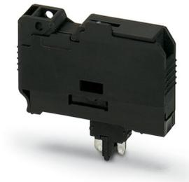
Sicherungsstecker, Vor dem Auswechseln der G-Sicherung, Sicherungsstecker aus der Grundklemme ziehen., Nennstrom: 10 A, Anschlussart: Steckanschluss, Sicherungstyp: G / 6,3 x 32, Montageart: Steckmontage, Farbe: schwarz
