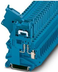
Hebeltrennklemme, Nennspannung: 500 V, Nennstrom: 20 A, Anschlussart: Schraubanschluss, Bemessungsquerschnitt: 4 mm<sup>2</sup>, Querschnitt: 0,14 mm<sup>2</sup> - 6 mm<sup>2</sup>, Montage: NS 35/7,5, NS 35/15, Farbe: blau
