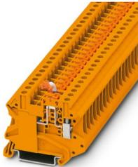
Messertrennklemme, mit Prüfbuchsen-schrauben zur Aufnahme von Prüfsteckern, Nennspannung: 500 V, Thermischer Dauerstrom  $I_{th}$ : 20 A, Anschlussart: Schraubanschluss, Bemessungsquerschnitt: 2,5 mm<sup>2</sup>, Querschnitt: 0,14 mm<sup>2</sup> - 6 mm<sup>2</sup>, Montage: NS 35/7,5, NS 35/15, Farbe: orange
