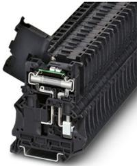
Sicherungsreihenklemme, Art der Sicherung: Glas / Keramik / ..., Sicherungstyp: G / 6,3 x 32, Nennspannung: 250 V, Nennstrom: 10 A, Anschlussart: Schraubanschluss, Bemessungsquerschnitt: 6 mm<sup>2</sup>, Querschnitt: 0,2 mm<sup>2</sup>- 10 mm<sup>2</sup>, Montageart: NS 35/7,5, NS 35/15, Farbe: schwarz
