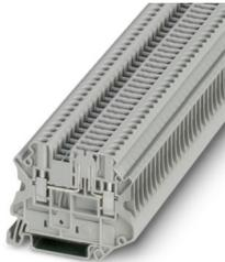
Trennklemme, Strom und Spannung werden durch den eingesetzten Stecker bestimmt., mit Prüfbuchschrauben zur Aufnahme von Prüfsteckern, Nennspannung: 400 V, Nennstrom: 20 A, Thermischer Dauerstrom  $I_{th}$ : 20 A, Anschlussart: Schraubanschluss, Bemessungsquerschnitt: 2,5 mm<sup>2</sup>, Querschnitt: 0,14 mm<sup>2</sup> - 4 mm<sup>2</sup>, Montage: NS 35/7,5, NS 35/15, Farbe: grau
