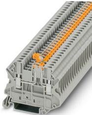
Messertrennklemme, Nennspannung: 500 V, Nennstrom: 20 A, Thermischer Dauerstrom  $I_{th}$ : 20 A, Anschlussart: Schraubanschluss, Bemessungsquerschnitt:  $2,5 \text{ mm}^2$ , Querschnitt:  $0,14 \text{ mm}^2 - 4 \text{ mm}^2$ , Montage: NS 35/7,5, NS 35/15, Farbe: grau
