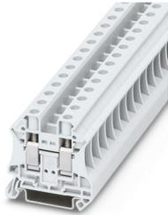
Durchgangsklemme, Nennspannung: 1000 V, Nennstrom: 57 A, Anzahl der Anschlüsse: 2, Anschlussart: Schraubanschluss, Bemessungsquerschnitt: 10 mm<sup>2</sup>, Querschnitt: 0,5 mm<sup>2</sup> - 16 mm<sup>2</sup>, Montageart: NS 35/7,5, NS 35/15, Farbe: weiß
