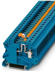
Messertrennklemme, mit Prüfbuchsen-schrauben zur Aufnahme von Prüfsteckern, Nennspannung: 500 V, Thermischer Dauerstrom  $I_{th}$ : 20 A, Anschlussart: Schraubanschluss, Bemessungsquerschnitt: 4 mm<sup>2</sup>, Querschnitt: 0,14 mm<sup>2</sup> - 6 mm<sup>2</sup>, Montage: NS 35/7,5, NS 35/15, Farbe: blau
