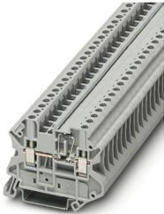
Bauelementreihenklemme, mit integrierter Diode 1N4007, Nennstrom: 0,5 A, Anzahl der Anschlüsse: 2, Anschlussart: Schraubanschluss, Bemessungsquerschnitt: 4 mm<sup>2</sup>, Querschnitt: 0,14 mm<sup>2</sup> - 6 mm<sup>2</sup>, Montageart: NS 35/7,5, NS 35/15, Farbe: grau
