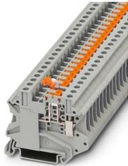
Messertrennklemme, mit Prüfbuchschrauben zur Aufnahme von Prüfsteckern, Nennspannung: 500 V, Nennstrom: 20 A, Anschlussart: Schraubanschluss, Bemessungsquerschnitt: 2,5 mm<sup>2</sup>, Querschnitt: 0,14 mm<sup>2</sup> - 6 mm<sup>2</sup>, Montage: NS 35/7,5, NS 35/15, Farbe: grau
