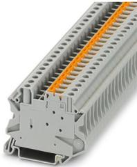
Messertrennklemme, mit 180° gedrehtem Trennmesser und Prüfbuchsen-schrauben zur Aufnahme von Prüfsteckern, Anschlussart: Schraubanschluss, Querschnitt: 0,14 mm<sup>2</sup> - 6 mm<sup>2</sup>, AWG: 26 - 10, Nennstrom: 20 A, Nennspannung: 500 V, Länge: 57,8 mm, Breite: 6,2 mm, Farbe: grau, Montage: NS 35/7,5, NS 35/15
