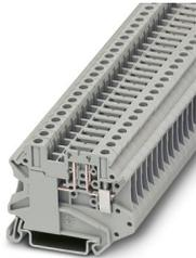
Trennklemme, Strom und Spannung werden durch den eingesetzten Stecker bestimmt., mit Prüfbuchschrauben zur Aufnahme von Prüfsteckern, Nennspannung: 500 V, Nennstrom: 20 A, Anschlussart: Schraubanschluss, Bemessungsquerschnitt: 4 mm<sup>2</sup>, Querschnitt: 0,14 mm<sup>2</sup> - 6 mm<sup>2</sup>, Montage: NS 35/7,5, NS 35/15, Farbe: grau
