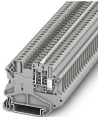
Messertrennklemme, mit Betätigungslasche, weißem Trennmesser und Prüfbuchschrauben zur Aufnahme von Prüfsteckern, Nennspannung: 500 V, Nennstrom: 20 A, Anschlussart: Schraubanschluss, Bemessungsquerschnitt: 2,5 mm<sup>2</sup>, Querschnitt: 0,14 mm<sup>2</sup> - 6 mm<sup>2</sup>, Montage: NS 35/7,5, NS 35/15, Farbe: grau
