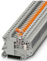
Messertrennklemme, Nennspannung: 500 V, Nennstrom: 20 A, Anschlussart: Schraubanschluss, Bemessungsquerschnitt: 2,5 mm<sup>2</sup>, Querschnitt: 0,14 mm<sup>2</sup> - 6 mm<sup>2</sup>, Montage: NS 35/7,5, NS 35/15, Farbe: grau
