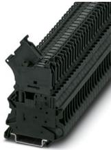
Sicherungsreihenklemme, Art der Sicherung: Glas / Keramik / ..., Sicherungstyp: G / 5 x 20, Nennspannung: 250 V, Nennstrom: 6,3 A, Anschlussart: Schraubanschluss, Bemessungsquerschnitt: 4 mm<sup>2</sup>, Querschnitt: 0,14 mm<sup>2</sup>- 6 mm<sup>2</sup>, Montageart: NS 35/7,5, NS 35/15, Farbe: schwarz
