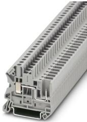
Durchgangsklemme, Nennspannung: 800 V, Nennstrom: 32 A, Anzahl der Anschlüsse: 2, Anschlussart: Schraub- / Steckanschluss, Bemessungsquerschnitt: 4 mm<sup>2</sup>, Querschnitt: 0,14 mm<sup>2</sup> - 6 mm<sup>2</sup>, Montageart: NS 35/7,5, NS 35/15, Farbe: grau
