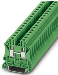
Durchgangsklemme, Nennspannung: 1000 V, Nennstrom: 41 A, Anzahl der Anschlüsse: 2, Anschlussart: Schraubanschluss, Bemessungsquerschnitt: 6 mm<sup>2</sup>, Querschnitt: 0,2 mm<sup>2</sup> - 10 mm<sup>2</sup>, Montageart: NS 35/7,5, NS 35/15, Farbe: grün
