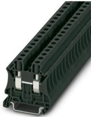
Durchgangsklemme, Nennspannung: 1000 V, Nennstrom: 41 A, Anzahl der Anschlüsse: 2, Anschlussart: Schraubanschluss, Bemessungsquerschnitt: 6 mm<sup>2</sup>, Querschnitt: 0,2 mm<sup>2</sup> - 10 mm<sup>2</sup>, Montageart: NS 35/7,5, NS 35/15, Farbe: schwarz
