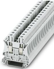
Durchgangsklemme, Nennspannung: 1000 V, Nennstrom: 41 A, Anzahl der Anschlüsse: 2, Anschlussart: Schraubanschluss, Bemessungsquerschnitt: 6 mm<sup>2</sup>, Querschnitt: 0,2 mm<sup>2</sup> - 10 mm<sup>2</sup>, Montageart: NS 35/7,5, NS 35/15, Farbe: weiß
