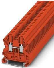
Durchgangsklemme, Nennspannung: 1000 V, Nennstrom: 32 A, Anzahl der Anschlüsse: 2, Anschlussart: Schraubanschluss, Bemessungsquerschnitt: 4 mm<sup>2</sup>, Querschnitt: 0,14 mm<sup>2</sup> - 6 mm<sup>2</sup>, Montageart: NS 35/7,5, NS 35/15, Farbe: rot
