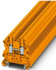
Durchgangsklemme, Nennspannung: 1000 V, Nennstrom: 32 A, Anzahl der Anschlüsse: 2, Anschlussart: Schraubanschluss, Bemessungsquerschnitt: 4 mm<sup>2</sup>, Querschnitt: 0,14 mm<sup>2</sup> - 6 mm<sup>2</sup>, Montageart: NS 35/7,5, NS 35/15, Farbe: orange
