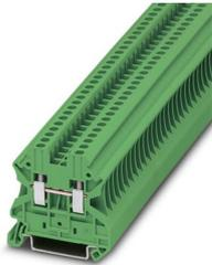
Durchgangsklemme, Nennspannung: 1000 V, Nennstrom: 24 A, Anzahl der Anschlüsse: 2, Anschlussart: Schraubanschluss, Bemessungsquerschnitt: 2,5 mm<sup>2</sup>, Querschnitt: 0,14 mm<sup>2</sup> - 4 mm<sup>2</sup>, Montageart: NS 35/7,5, NS 35/15, Farbe: grün
