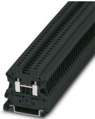
Durchgangsklemme, Nennspannung: 1000 V, Nennstrom: 24 A, Anzahl der Anschlüsse: 2, Anschlussart: Schraubanschluss, Bemessungsquerschnitt: 2,5 mm<sup>2</sup>, Querschnitt: 0,14 mm<sup>2</sup> - 4 mm<sup>2</sup>, Montageart: NS 35/7,5, NS 35/15, Farbe: schwarz
