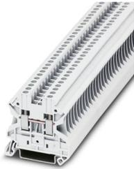
Durchgangsklemme, Nennspannung: 1000 V, Nennstrom: 24 A, Anzahl der Anschlüsse: 2, Anschlussart: Schraubanschluss, Bemessungsquerschnitt: 2,5 mm<sup>2</sup>, Querschnitt: 0,14 mm<sup>2</sup> - 4 mm<sup>2</sup>, Montageart: NS 35/7,5, NS 35/15, Farbe: weiß
