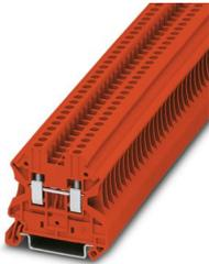
Durchgangsklemme, Nennspannung: 1000 V, Nennstrom: 24 A, Anzahl der Anschlüsse: 2, Anschlussart: Schraubanschluss, Bemessungsquerschnitt: 2,5 mm<sup>2</sup>, Querschnitt: 0,14 mm<sup>2</sup> - 4 mm<sup>2</sup>, Montageart: NS 35/7,5, NS 35/15, Farbe: rot
