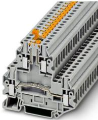
Messertrennklemme, Nennspannung: 500 V, Nennstrom: 30 A, Anschlussart: Schraubanschluss, Bemessungsquerschnitt: 4 mm<sup>2</sup>, Querschnitt: 0,14 mm<sup>2</sup> - 6 mm<sup>2</sup>, Trennzone, Montage: NS 35/7,5, NS 35/15, Farbe: grau
