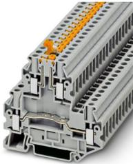
Messertrennklemme, mit Prüfbuchsen-schrauben zur Aufnahme von Prüfsteckern, Nennspannung: 500 V, Nennstrom: 30 A, Anschlussart: Schraubanschluss, Bemessungsquerschnitt: 4 mm<sup>2</sup>, Querschnitt: 0,14 mm<sup>2</sup> - 6 mm<sup>2</sup>, Trennzone, Montage: NS 35/7,5, NS 35/15, Farbe: grau
