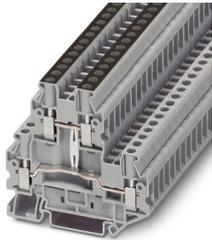
Doppelstockklemme, mit Potenzialverbinder, Nennspannung: 800 V, Nennstrom: 30 A, Anschlussart: Schraubanschluss, Bemessungsquerschnitt: 4 mm<sup>2</sup>, Querschnitt: 0,14 mm<sup>2</sup> - 6 mm<sup>2</sup>, Montageart: NS 35/7,5, NS 35/15, Farbe: grau
