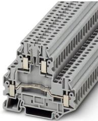
Trennklemme, Strom und Spannung werden durch den eingesetzten Stecker bestimmt., Nennspannung: 500 V, Nennstrom: 30 A, Anschlussart: Schraubanschluss, Bemessungsquerschnitt: 4 mm<sup>2</sup>, Querschnitt: 0,14 mm<sup>2</sup> - 6 mm<sup>2</sup>, Trennzone, Montage: NS 35/7,5, NS 35/15, Farbe: grau
