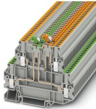
Messertrennklemme, Nennspannung: 400 V, Nennstrom: 16 A, Anschlussart: Schraubanschluss, Bemessungsquerschnitt: 2,5 mm<sup>2</sup>, Querschnitt: 0,14 mm<sup>2</sup> - 4 mm<sup>2</sup>, Anschlussart: Schraubanschluss, Bemessungsquerschnitt: 2,5 mm<sup>2</sup>, Querschnitt: 0,14 mm<sup>2</sup> - 4 mm<sup>2</sup>, Montage: NS 35/7,5, NS 35/15, Farbe: grau
