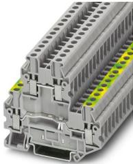
Mehrstockklemme, Nennspannung: 500 V, Nennstrom: 24 A, Anschlussart: Schraubanschluss, Bemessungsquerschnitt: 2,5 mm<sup>2</sup>, Querschnitt: 0,14 mm<sup>2</sup> - 4 mm<sup>2</sup>, Montageart: NS 35/7,5, NS 35/15, Farbe: grau
