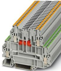
Trennklemme, Strom und Spannung werden durch den eingesetzten Stecker bestimmt., mit Prüfbuchschrauben zur Aufnahme von Prüfsteckern, Nennspannung: 400 V, Thermischer Dauerstrom  $I_{th}$ : 16 A, Anschlussart: Schraubanschluss, Bemessungsquerschnitt: 2,5 mm<sup>2</sup>, Querschnitt: 0,14 mm<sup>2</sup> - 4 mm<sup>2</sup>, Anschlussart: Schraubanschluss, Bemessungsquerschnitt: 2,5 mm<sup>2</sup>, Querschnitt: 0,14 mm<sup>2</sup> - 4 mm<sup>2</sup>, Montage: NS 35/7,5, NS 35/15, Farbe: grau
