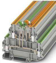
Messertrennklemme, mit Prüfbuchsen-schrauben zur Aufnahme von Prüfsteckern, Nennspannung: 400 V, Nennstrom: 16 A, Anschlussart: Schraubanschluss, Bemessungsquerschnitt: 2,5 mm<sup>2</sup>, Querschnitt: 0,14 mm<sup>2</sup> - 4 mm<sup>2</sup>, Anschlussart: Schraubanschluss, Bemessungsquerschnitt: 2,5 mm<sup>2</sup>, Querschnitt: 0,14 mm<sup>2</sup> - 4 mm<sup>2</sup>, Montage: NS 35/7,5, NS 35/15, Farbe: grau
