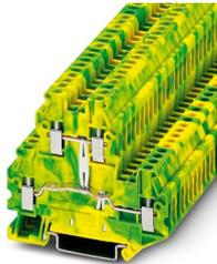
Schutzleiter-Doppelstockklemme, Anzahl der Anschlüsse: 4, Anschlussart: Schraubanschluss, Querschnitt: 0,14 mm<sup>2</sup> - 4 mm<sup>2</sup>, Montageart: NS 35/7,5, NS 35/15, Farbe: grün-gelb
