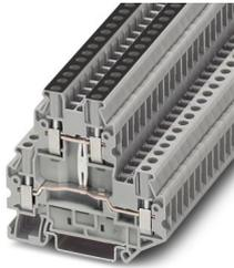
Doppelstockklemme, mit Potenzialverbinder, Nennspannung: 500 V, Nennstrom: 24 A, Anschlussart: Schraubanschluss, Bemessungsquerschnitt: 2,5 mm<sup>2</sup>, Querschnitt: 0,14 mm<sup>2</sup> - 4 mm<sup>2</sup>, Montageart: NS 35/7,5, NS 35/15, Farbe: grau
