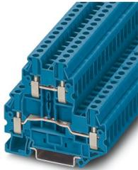
Doppelstockklemme, Nennspannung: 500 V, Nennstrom: 24 A, Anschlussart: Schraubanschluss, Bemessungsquerschnitt: 2,5 mm<sup>2</sup>, Querschnitt: 0,14 mm<sup>2</sup> - 4 mm<sup>2</sup>, Montageart: NS 35/7,5, NS 35/15, Farbe: blau
