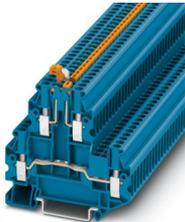
Messertrennklemme, mit Prüfbuchenschrauben zur Aufnahme von Prüfsteckern, Nennspannung: 400 V, Nennstrom: 22 A, Anschlussart: Schraubanschluss, Bemessungsquerschnitt: 2,5 mm<sup>2</sup>, Querschnitt: 0,14 mm<sup>2</sup> - 4 mm<sup>2</sup>, Anschlussart: Schraubanschluss, Bemessungsquerschnitt: 2,5 mm<sup>2</sup>, Querschnitt: 0,14 mm<sup>2</sup> - 4 mm<sup>2</sup>, Montage: NS 35/7,5, NS 35/15, Farbe: blau
