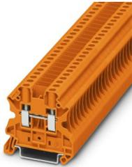
Durchgangsklemme, mit herausbrechbarer Trennwand im Brückenschacht, Nennspannung: 1000 V, Nennstrom: 32 A, Anzahl der Anschlüsse: 2, Polzahl: 1, Anschlussart: Schraubanschluss, Bemessungsquerschnitt: 4 mm<sup>2</sup>, Querschnitt: 0,14 mm<sup>2</sup> - 6 mm<sup>2</sup>, Montageart: NS 35/7,5, NS 35/15, Farbe: orange
