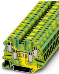
Schutzleiter-Reihenklemme, Anzahl der Anschlüsse: 4, Anschlussart: Schraubanschluss, 1. Etage, Querschnitt: 0,14 mm<sup>2</sup> - 6 mm<sup>2</sup>, Montageart: NS 35/7,5, NS 35/15, Farbe: grün-gelb
