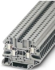
Durchgangsklemme, Nennspannung: 500 V, Nennstrom: 32 A, Anzahl der Anschlüsse: 4, Anschlussart: Schraubanschluss, Bemessungsquerschnitt: 4 mm<sup>2</sup>, Querschnitt: 0,14 mm<sup>2</sup> - 6 mm<sup>2</sup>, Montageart: NS 35/7,5, NS 35/15, Farbe: grau
