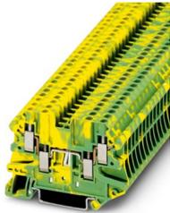
Schutzleiter-Reihenklemme, Anzahl der Anschlüsse: 4, Anschlussart: Schraubanschluss, Querschnitt:  $0,14 \text{ mm}^2 - 4 \text{ mm}^2$ , Montageart: NS 35/7,5, NS 35/15, Farbe: grün-gelb
