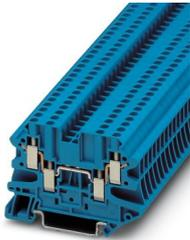
Durchgangsklemme, Nennspannung: 500 V, Nennstrom: 24 A, Anzahl der Anschlüsse: 4, Anschlussart: Schraubanschluss, Bemessungsquerschnitt: 2,5 mm<sup>2</sup>, Querschnitt: 0,14 mm<sup>2</sup> - 4 mm<sup>2</sup>, Montageart: NS 35/7,5, NS 35/15, Farbe: blau
