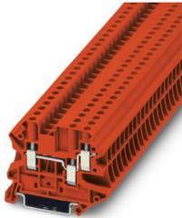
Durchgangsklemme, Nennspannung: 500 V, Nennstrom: 32 A, Anzahl der Anschlüsse: 3, Anschlussart: Schraubanschluss, Bemessungsquerschnitt: 4 mm<sup>2</sup>, Querschnitt: 0,14 mm<sup>2</sup> - 6 mm<sup>2</sup>, Montageart: NS 35/7,5, NS 35/15, Farbe: rot
