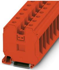
Durchgangsklemme, Nennspannung: 1000 V, Nennstrom: 125 A, Anzahl der Anschlüsse: 2, Anschlussart: Schraubanschluss, Bemessungsquerschnitt: 35 mm<sup>2</sup>, Querschnitt: 1,5 mm<sup>2</sup> - 50 mm<sup>2</sup>, Montageart: NS 35/7,5, NS 35/15, Farbe: rot
