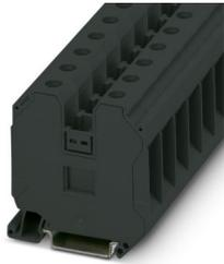
Durchgangsklemme, Nennspannung: 1000 V, Nennstrom: 125 A, Anzahl der Anschlüsse: 2, Anschlussart: Schraubanschluss, Bemessungsquerschnitt: 35 mm<sup>2</sup>, Querschnitt: 1,5 mm<sup>2</sup> - 50 mm<sup>2</sup>, Montageart: NS 35/7,5, NS 35/15, Farbe: schwarz
